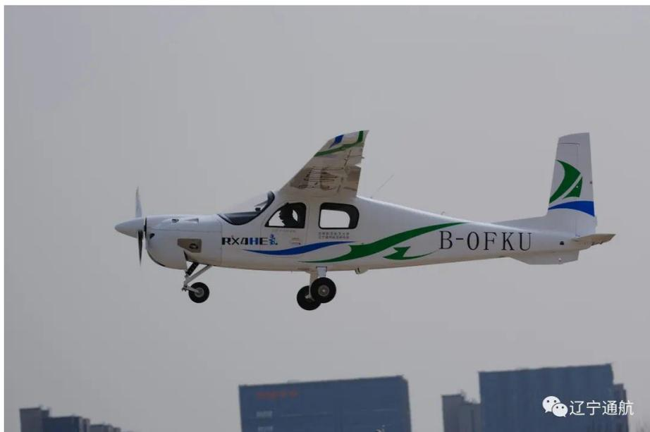
由于氢内燃机对氢气纯度没有特殊要求，并且可以使用内燃机行业已有的技术和生产线，因此与氢燃料电池相比更具价格优势。该飞机使用氢作为动力来源，具有热值高、无污染、资源来源广泛等优点，在降低碳排放的同时保持较高的工作效率，有助于在航空业尽早实现双碳目标。
