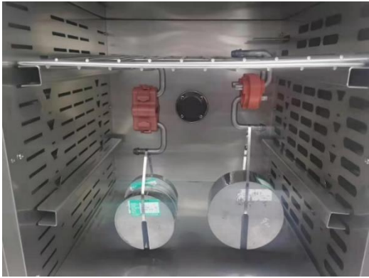
图 8 减震器蠕变试验
