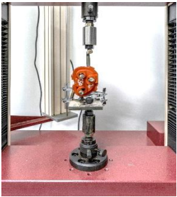
图 5 静刚度测试
