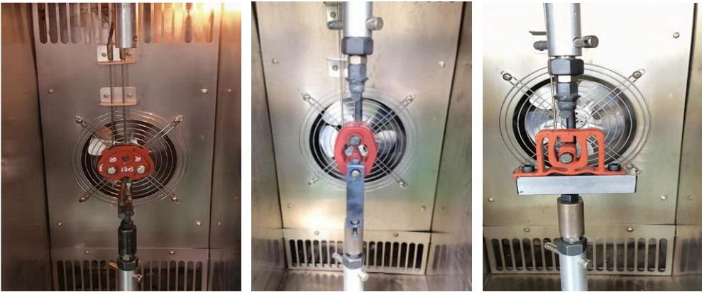
图 7 减震器耐久试验
